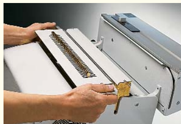
Schneller und problemloser Werkzeugwechsel in 1-2 Minuten
