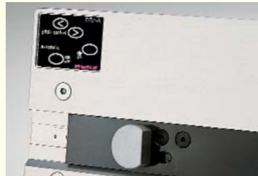
Butée de papier avec cellule qui déclenche l'opération de perforation
